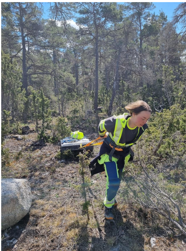
Figur 3: Markradar med skärmad GX 80 MHz antenn. Här syns Frida Strand kämpa med dragningen längs den västliga profilen.
