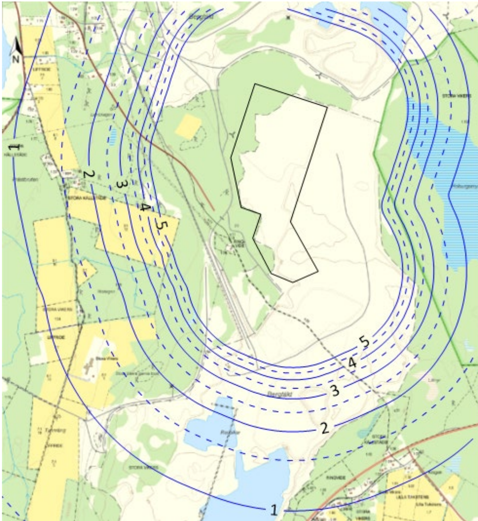
Figur 3.7. Prognostiserade maximala vibrationsnivåer i Norra Klinthagen. Högst vibrationer vid bostadshus är prognostiserade både till området väst och syd om brytområdet där bostäder maximalt beräknas få vibrationer strax över 1,8 mm/s.
