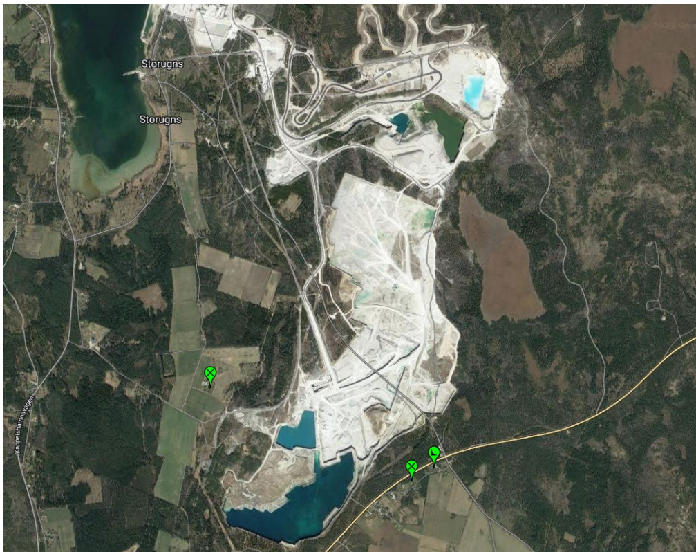
Figur 3.2. Positioner för vibrationsmätning och luftstöt vågsmätning (gröna figurer). Till vänster i figuren ligger Stora Vikers 6:1 vibrationsmätning och till höger Stora Källstäde 1:35 vibrationsmätning samt Lilla Takstens 1:20 vibrationsmätning och luftstöt vågsmätning.
