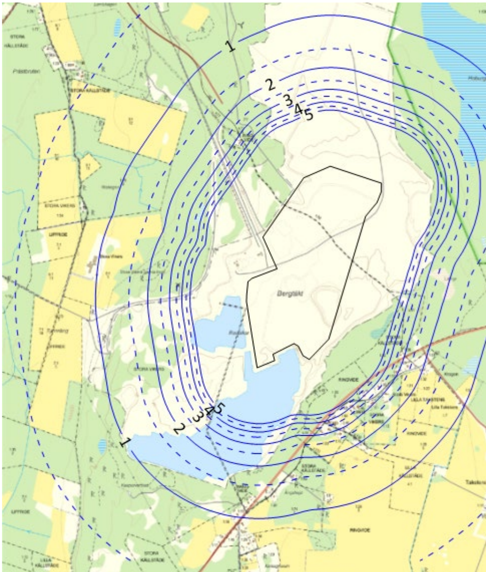
Figur 3.5. Prognostiserade maximala vibrationsnivåer i Centrala Klinthagen. Högst vibrationer vid bostadshus är prognostiserade till området Lilla Takstens sydost om brytområdet där maximal nivå kommer att bli 4 mm/s.
