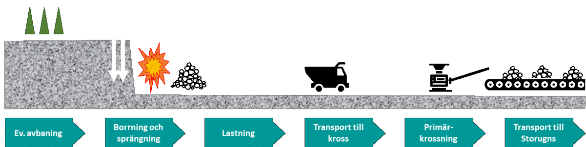
Figur 2. Materialflödet i Klinthagen kräver en god planering mellan flera olika arbetsmoment för att hålla ett så jämt produktionsflyt som möjligt i verksamheten.
